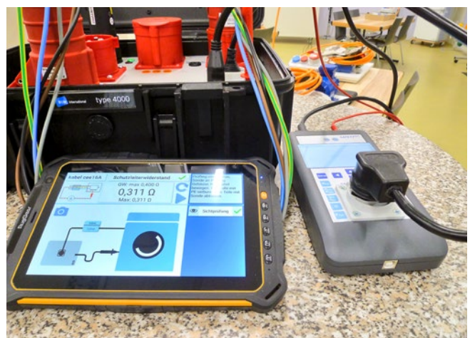
[FIG. 1] Verifica degli apparecchi secondo la norma SNR 462638 (fonte: as-energie GmbH).
